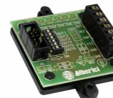
Per gettoniera elettronica con 1 OUT selezionabile da dip switch + accumulatore (AL031S)
