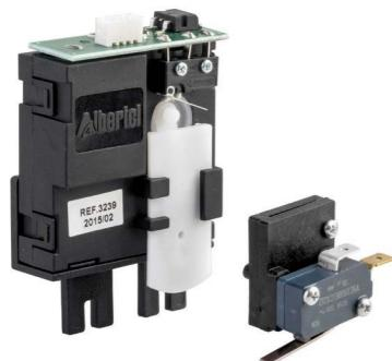
Disponibile per attivazione impulsiva o per pilotaggio ccTalk. Il Kit di scarto elettronico si monta su Supporto a C e include micro di attivazione.
