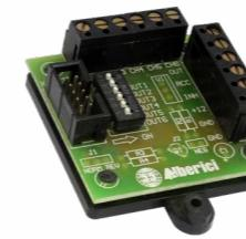
Per gettoniera elettronica con 6 OUT paralleli e 1 OUT accumulatore selezionabile da dip-switch (AL031DS)
