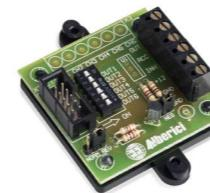
Per gettoniera elettronica con 1 OUT accumulatore, selezionabile da Dipswitch. Con jumper per la selezione del segnale di inibizione (AL031I) For electronic coin acceptor with 1 multi-pulse OUT, selectable by Dip-switch. With jumper to set the inhibit signal polarity (AL031I)
